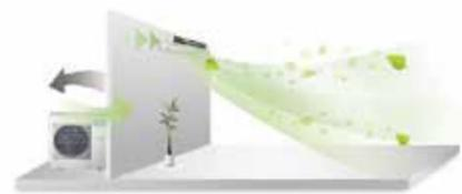
L'apport d'air extérieur peut être réalisé directement dans l'unité par une ouverture découpée sur le côté du corps de la machine, ce qui permet d'obtenir un air plus propre et plus frais.
