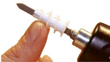
Insérer l'embout dans la visseuse, puis la cheville RAMTWIST dans l'embout
