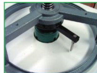
Adaptation à l'aide de la scie-trépan
