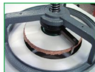
Utilisation de l'adaptateur rénovation sur Multispot, Maxi, Mega et Giga.
