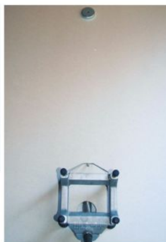
Localisation du flexible avec l'aimant
