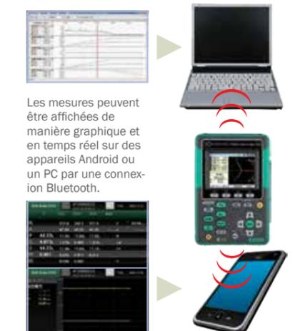
Les mesures peuvent être affichées de manière graphique et en temps réel sur des appareils Android ou un PC par une connexion Bluetooth.
