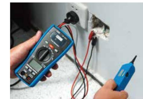
Tester sans assistance le câblage dans l'armoire en connectant simplement les pinces crocodile aux gaines aux prises de contact.
