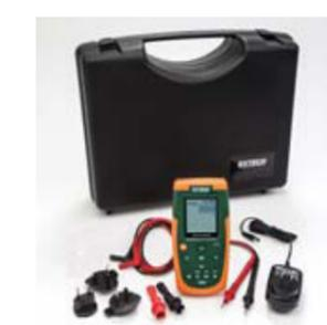
Complet avec cordons de test, pinces crocodiles, câble d'étalonnage de thermocouple avec connecteur subminiature, câble d'étalonnage universel avec borne subminiature, adaptateur universel 100 V-240 V CA avec 4 prises, six piles AA 1,5 V et étui de transport rigide
