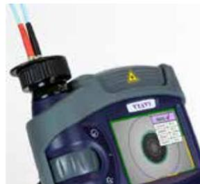
Il est équipé d'une sonde d'inspection et d'un microscope de connecteur de jarretière pour permettre aux techniciens de gagner un temps précieux lors de l'inspection des jarretières optiques et des connecteurs de traversées.
