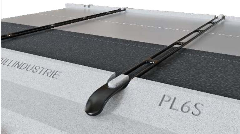
Utilisez les ergots afin de **bien tendre** les élastomères de fixation et ainsi lier le plénum de soufflage et de reprise. *Pensez également à en placer par le dessous !*
