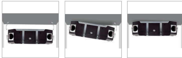
Fixation du CADS FLEXEO grâce aux supports fournis
