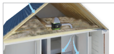
Pose dans les combles
