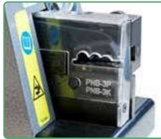
PNB-3P détail de la zone de sertissage
