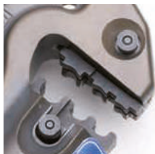
Couple de matrices polarisées à monter sans outil
