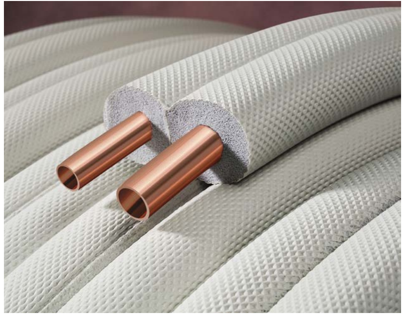
Isolant en polyéthylène réticulé, ignifugé de 10 mm, revêtu d'un film protecteur (épaisseur 50 µm).
