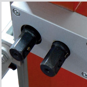
Système de progression à double vitesse du chariot moteur
